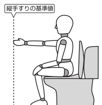
縦手すり設置位置の採寸 (図2)縦手すりの設定位置
