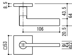
●材質:亜鉛ダイキャスト ●扉厚:33~42mm ●パックセット:51mm ●付属品:LJケース、取付ビス、ストライク
