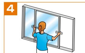
●窓枠にもどしてガタツキがあれば再度調整ねじで高さ調整してください。
