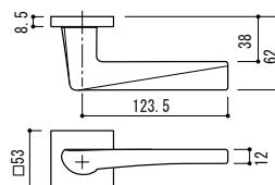
●材質:亜鉛ダイキャスト ●扉厚:33~42mm ●パックセット:51mm ●付属品:LJケース、取付ビス、ストライク
