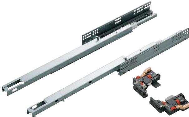
■三次元調整機能付。ダイヤルの操作で引き出しの位置を上下2.5mm、前後3mm、左右±1.5mmの範囲で調整できます。
