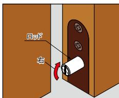
●ロッドの芯部のみ右に90°回転させます。ロッドの芯の金属部をマイナスドライバーで右に90°回してください。(樹脂の溝より90°回す。)
