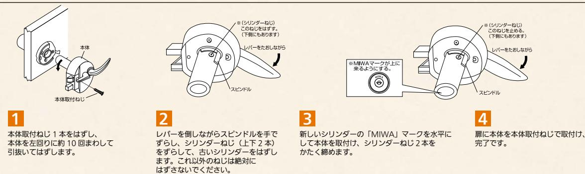
1 本体取付ねじ1本をはずし、本体を左回りに約10回まわして引抜いてはずします。
