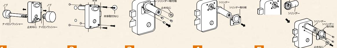
1 室内側の止めねじをゆるめて、ノブをはずします。
