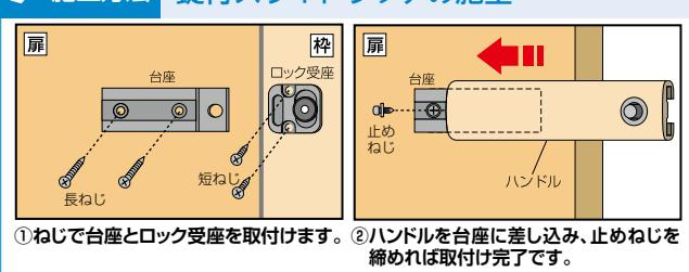
①ねじで台座とロック受座を取付けます。②ハンドルを台座に差し込み、止めねじを締めれば取付け完了です。
