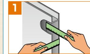
●溝幅と溝の深さを測ります。
