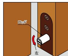
●ロッドの芯部のみ左に90°回転させます。ロッドの芯の金属部をマイナスドライバーで90°左に回してください。(樹脂の溝の位置合わせる。)
