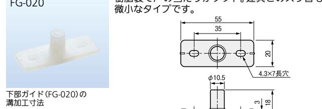
下部ガイド (FG-020)の溝加工寸法
