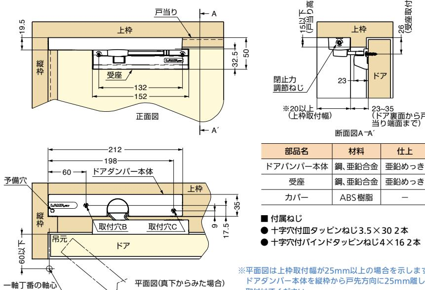
※平面図は上枠取付幅が25mm以上の場合を示します。上枠取付幅が20mm以上25mm未満の場合は、
