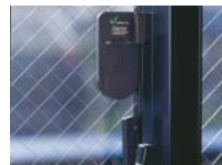
ガラス破壊と窓の開閉をダブル検知。
