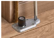
床付ガイドピン 扉を吊りこんだまま前後調整が可能(前後±2mm)
