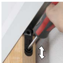
上下調整(上3mm、下2mm)
