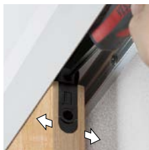
前後調整(前後±2mm) ※吊り車の前後調整はレール内のランナー本体にあります。
