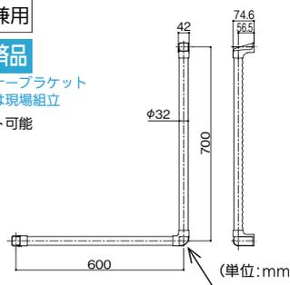
※コーナーブラケットの取付け方向を変え右勝手・左勝手を調整します。
