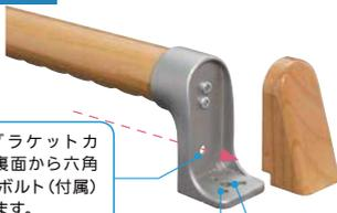
木製のブラケットカバーは、裏面から六角穴付き皿ボルト(付属)で固定します。
