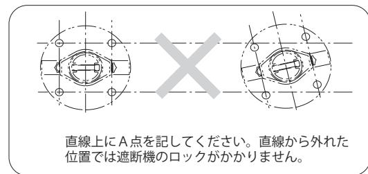
②マーキングしたA点に振動ドリル(ドリル径10mm)にて、深さ55mmの穴を開け、付属のナイロンアンカーMG10を挿入します。
