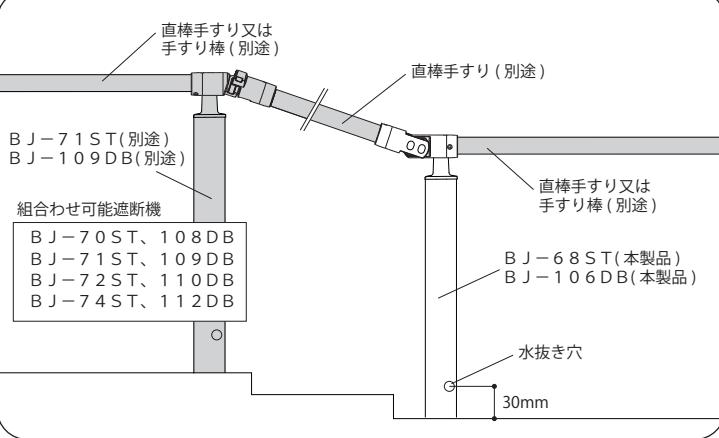
■遮断機式軸側埋め込み式支柱【BJ-68ST、BJ-106DB】外観図
