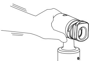
**⚠ 施工上のご注意 必ず手すり棒を取り付ける前に化粧カバーを取付けてください。**
