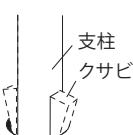
④ 穴にモルタルを流し込み、モルタルが仮硬化したらクサビを取り除いてクサビ跡をモルタルで補修します。
