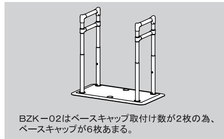
! • 使用しない支柱取付け穴には必ずベースキャップをはめる。
