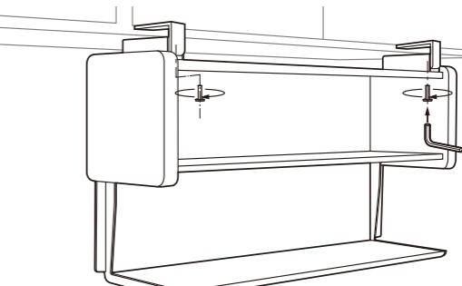
● 付属の六角レンチでボルトを締めます。
