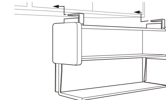
● 戸棚に金具を引掛けます。※引掛け金具は 7mm~30mm まで対応します。
