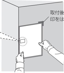
① ミラーは手で強く押して貼り付けてください。接着剤が硬化するとミラーが固定されます。(24時間以上)
